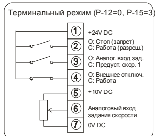
Аналоговое задание скорости с одной предуст. скоростью и термистором
