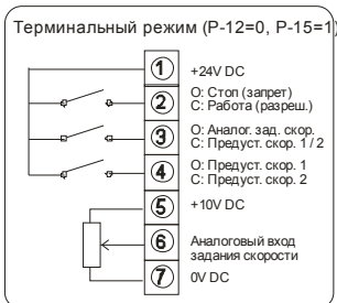
Аналоговое задание скорости с двумя предустановленными скоростями
